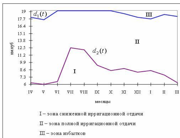
Рис. 30. Диспетчерские линии d_1(t) и d_2(t) , найденные на первом варианте.
